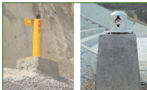
Рис. 10 Примеры защиты отражателей от пыли, дождя, снега и вандалов (Китай)
