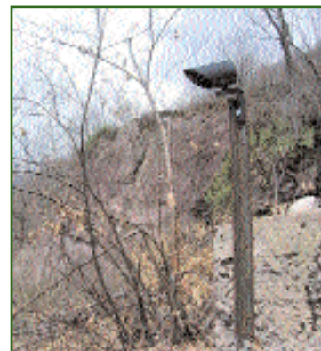
Рис. 9 Металлический стакан защищает отражатель от пыли, дождя и снега (Италия)
