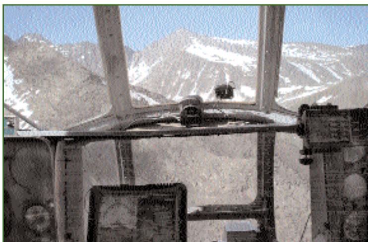
Рис. 1 МИНС в кабине вертолета Ми-8
